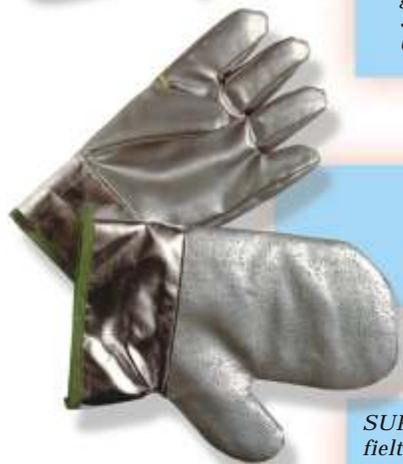
*DEMOLÉUR: Manopla en tejido Kermel rizado, 1300 grs/m<sup>2</sup>, refuerzo de Kevlar en pulgar, manguito serraje, largo 38 cms., T/10. Cat. 3, para uso de unos 500° C.*
