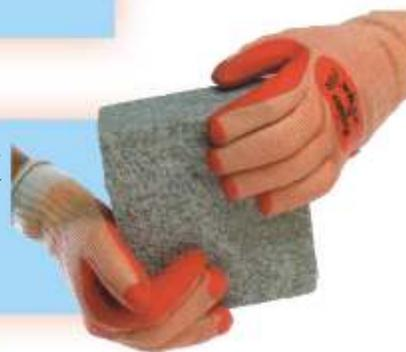
*J-RGT 099V: Guante anti-corte medio, 73% poliamida, 27% algodón, en colores blanco y oliva, también con puntos de PVC para mayor agarre. Buena resistencia a la abrasión (2). Para industria del automóvil, montaje metálico, vidrio, etc. T/7,9.*
